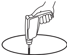
Trou de dégagement
