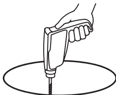
Trou de dégagement
