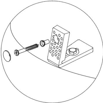
8. Serrez les vis de fixation de la cuvette aux supports de montage. Placez les capuchons sur les têtes de vis.
