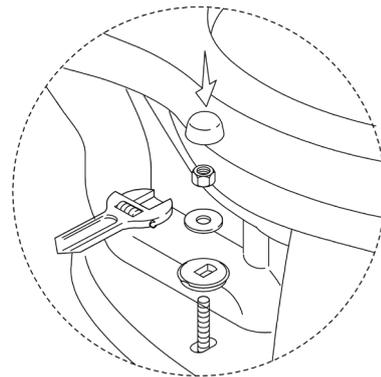
**\*\* REMARQUE:** Ne serrez pas trop les écrous. La porcelaine est fragile et pourrait se fêler si les écrous sont trop serrés. \*\*
