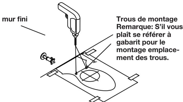
**\*\* REMARQUE:** Pour des sols d'une épaisseur inférieure à 1-1 / 2" (38 mm), utilisez une mèche de 5/32". Pour les sols d'une épaisseur supérieure à 1/2" (38 mm), utilisez une mèche de 3/8" (nécessaire) pour l'installation de l'ancrage. \*\*
