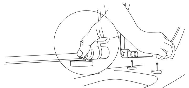
Pour réinstaller le siège. Alignez les goupilles du siège avec les douilles de charnière du siège et appliquez une pres-sion vers le bas jusqu'à ce que vous sentiez et entendiez un «clic». Ce «clic» signifie que la goupille du siège est ver-rouillée en position.
