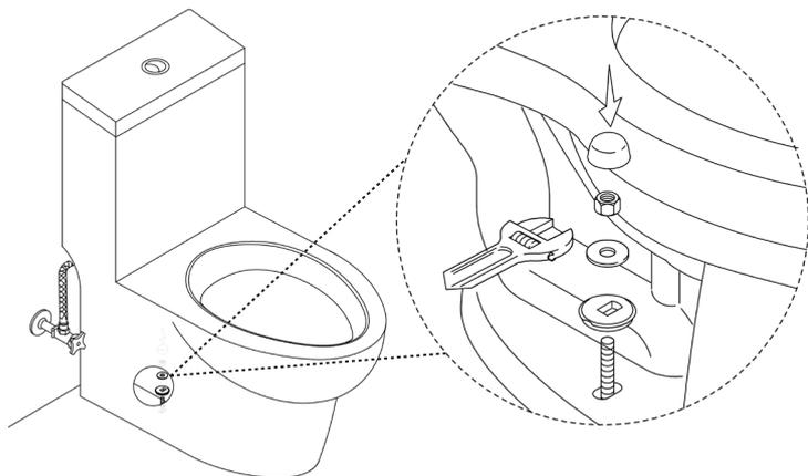
**\*\* REMARQUE:** Ne serrez pas trop les écrous. La porcelaine est fragile et pourrait se fêler si les écrous sont trop serrés. **\*\***
