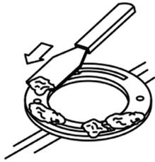
**\*\* REMARQUE:** La surface d'installation doit être propre et nivelée avant l'installation de nouveaux WC. \*\*
