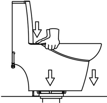
7. Ajustez les supports de montage en plastique de sorte qu'ils soient alignés avec l'emplacement du trou de montage sur les WC.
